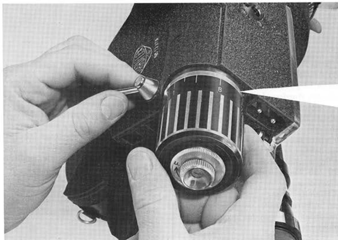
II. 05 Anschließen des Motorkabels an Kamera und Stromquelle
